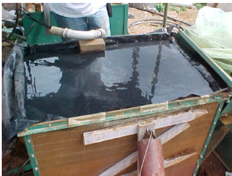
Figura 17 – Estabelecimento da lâmina d'água inicial sobre a superfície do solo.
