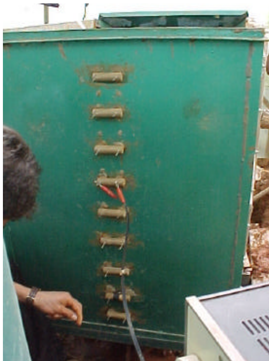
Figura 14 – Sonda de TDR construída para o acompanhamento da frente de umedecimento (a); e instalação destas na lateral da caixa de solo (b).
