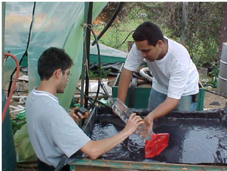
Figura 18 – Determinação da vazão de água aplicada sobre a caixa de solo.
