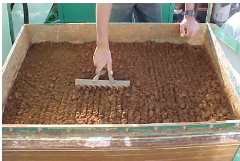
Figura 12 – Vista da caixa de acomodação no momento da realização de ranhuras antes de ser colocada a próxima camada de solo.
