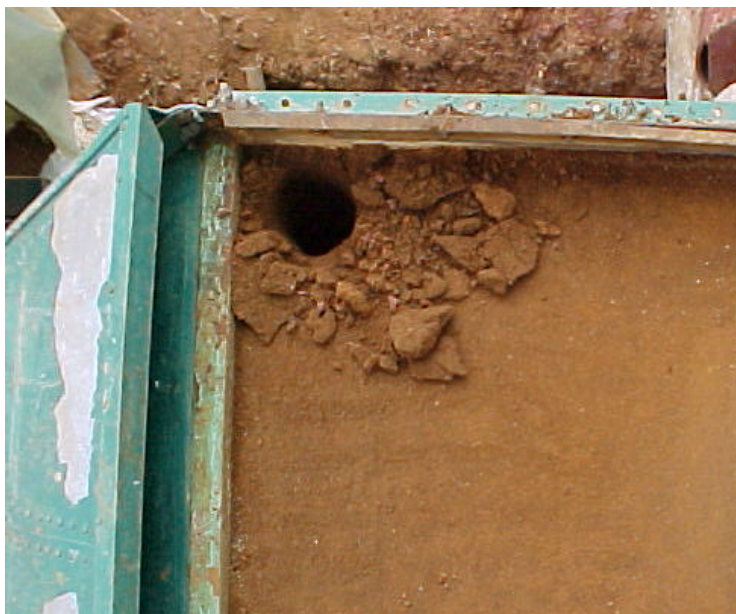
Figura 16 – Furo de trado feito para retirada de amostras para determinação da umidade inicial (vista de cima).
