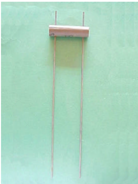
Figura 14 – Sonda de TDR construída para o acompanhamento da frente de umedecimento (a); e instalação destas na lateral da caixa de solo (b).
