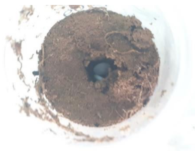
Figura 14. Imagem fotográfica das Microesferas colocadas no centro do solo para estudos de lixiviação.
