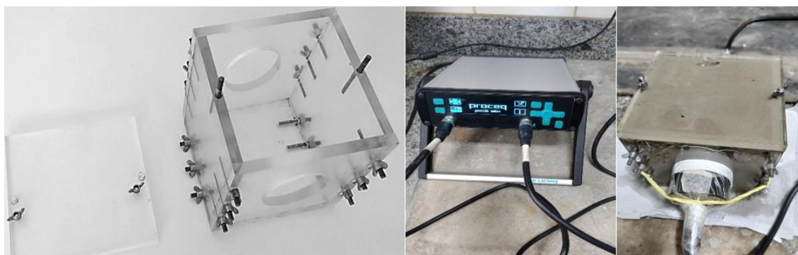
Figura 2.5 - a) Caixa cúbica em acrílico para testes de VPU; b) Equipamento acoplado à caixa de acrílico (UFV).
