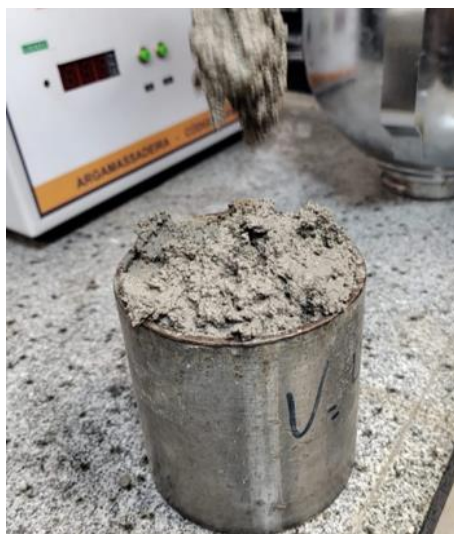
Figura 4.2 - Ensaio para determinação do teor de ar incorporado das argamassas.
