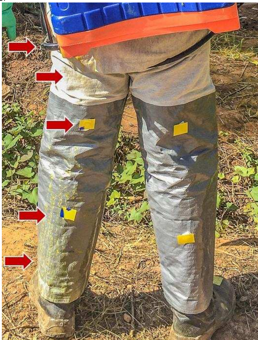
Figura 17 – Derramamento de calda na conexão da alavanca de acionamento com o tanque do pulverizador
