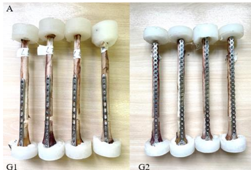
(A) Posicionamento das placas fixadas nos rádios de Lobo-guará para o ensaio de compressão axial estático. Divisão dos grupos: placa LCP (G1) e nova placa T (G2). Fonte: elaborada pela autora (2022).
