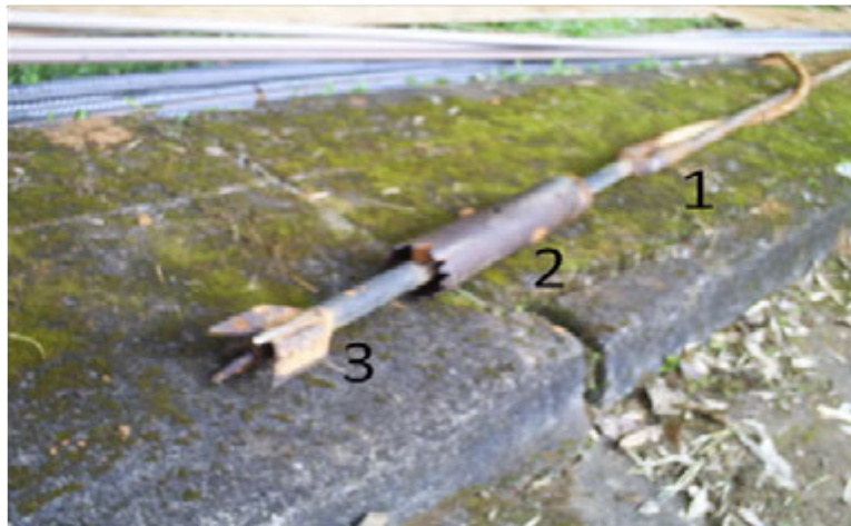
Figura 20. Trado manual com circulação de água utilizado
