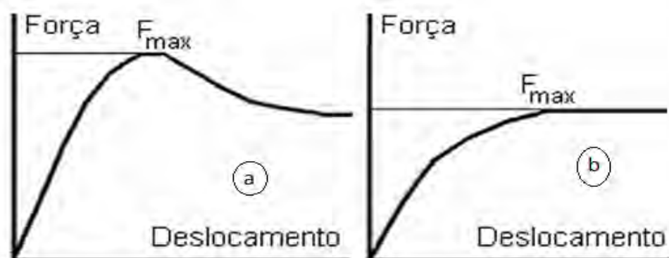
Figura 11. Critério para Carga de Arrancamento segundo Clouterre (1991) modificado por Springer (2006), (a) Força máxima obtida através do valor de pico, (b) Força de arrancamento que gera um deslocamento contínuo Fonte: Adaptado Clouterre (1991)
