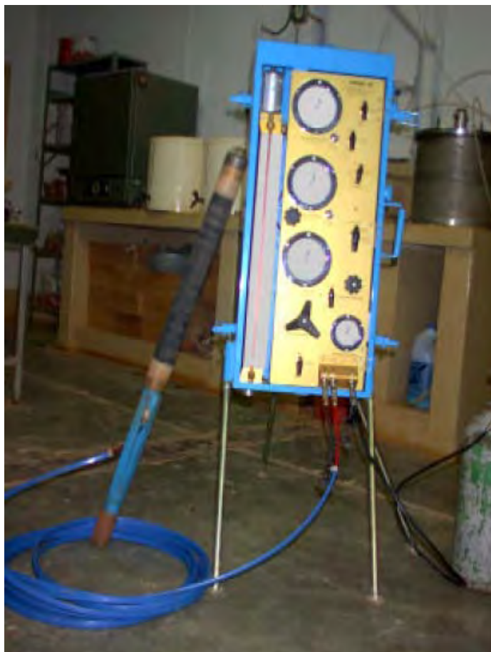
Figura 41. Pressiômetro de Menard do Departamento de Engenharia Civil da UFV Fonte: CUSTÓDIO (2003)
