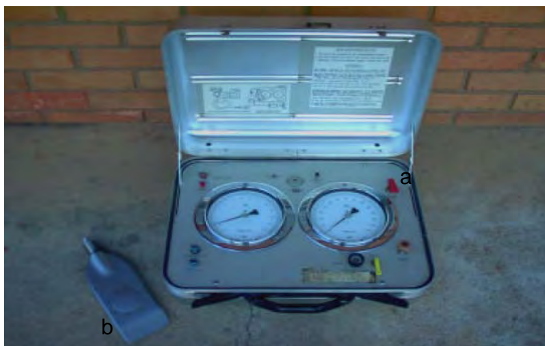
Figura 43. Caixa de controle (a) e lâmina dilatométrica (b) Fonte: CUSTÓDIO (2003)
