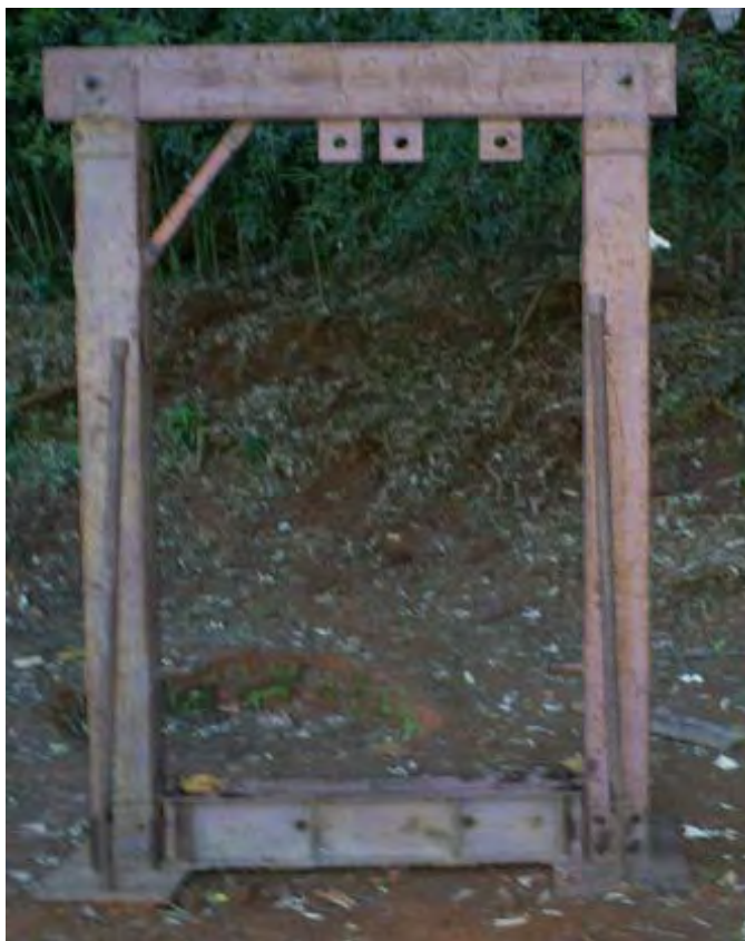
Figura 44. Pórtico de reação para cravação da lâmina dilatométrica
