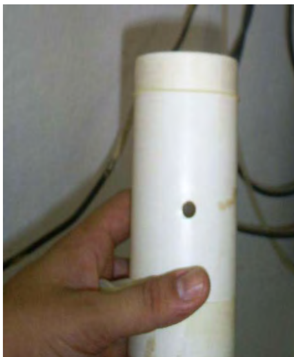
Figura 37. Tubo de PVC furado que auxilia na colocação da membrana
