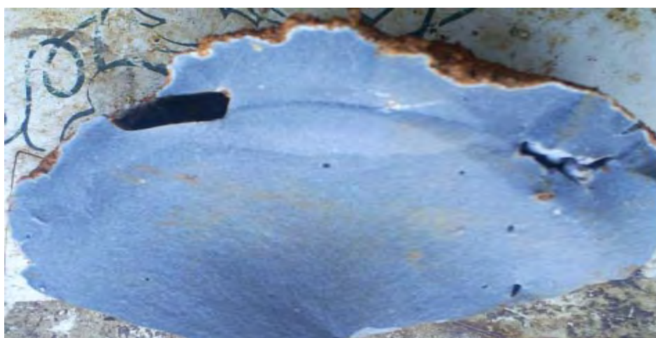
Figura 74. Detalhe de vazios e redução de área na nata do grampo 6
