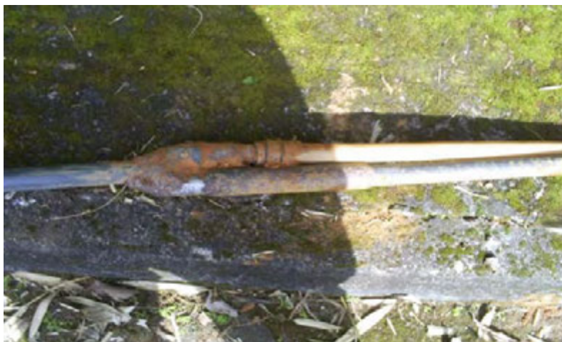
Figura 21. Detalhe adaptação da mangueira para permitir a circulação de água na ponta do equipamento.
