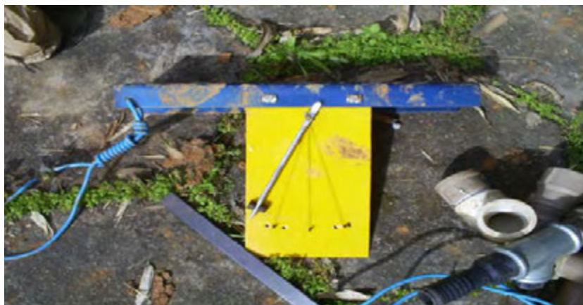
Figura 23. Equipamento utilizado para determinação da inclinação dos grampos
