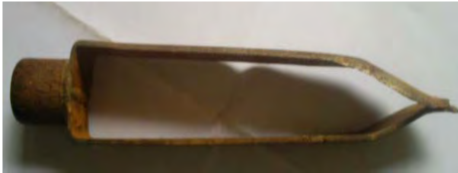
Figura 42. Trado manual tipo cônico utilizado no ensaio PMT
