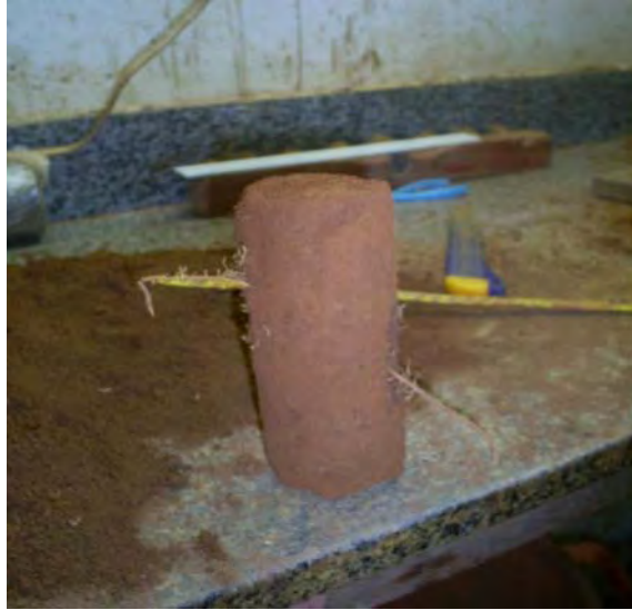
Figura 35. Corpo de prova moldado, com presença de raízes
