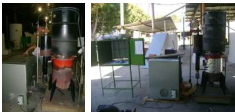
Figura 10. Processo de secagem de banana via gaseificação de carvão vegetal.
