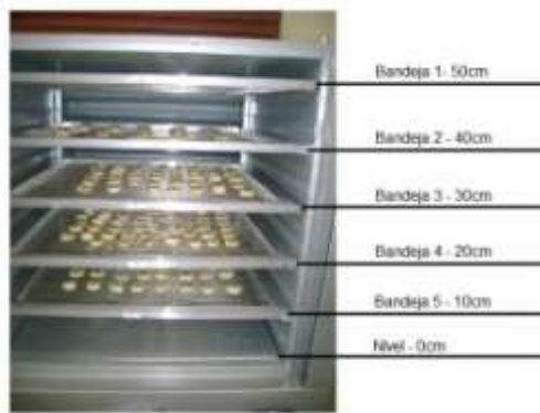
Figura 13. Vista parcial da disposição das bandejas com amostras dentro do secador.
