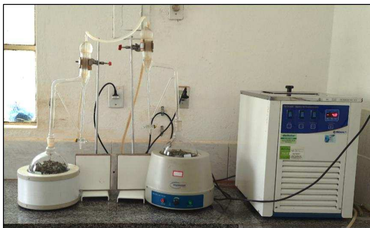
Figura 3 – Extração de óleo essencial de manjerição pelo método da hidrodestilação
