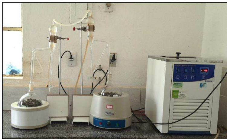
Figura 7 – Extração de óleo essencial de manjeriço pelo método da hidrodestilação
