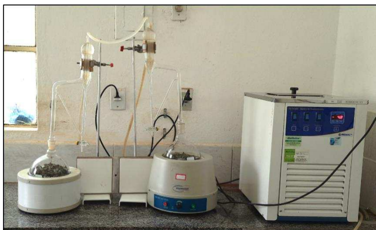
Figura 3 – Extração de óleo essencial de manjeriço pelo método da hidrodestilação
