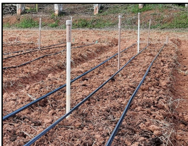
Figura 4 – Tensiômetros instalados nas unidades experimentais para monitoramento da tensão de água no solo
