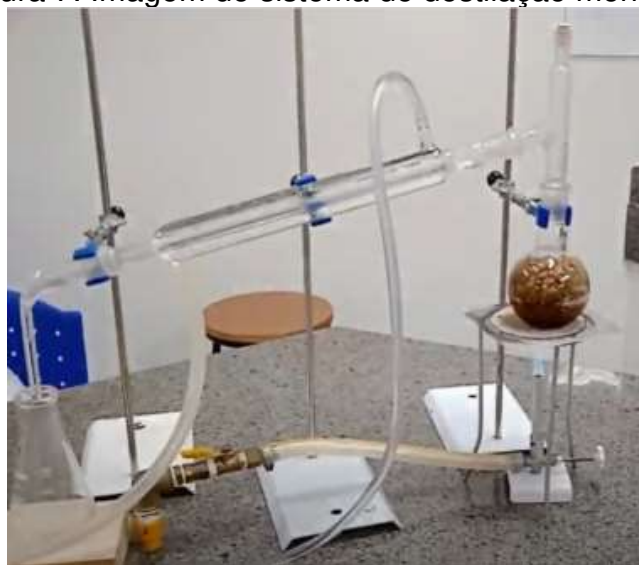
Figura 7. Imagem do sistema de destilação montado
