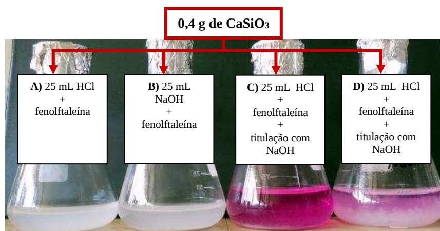
Figura 1.5. 0,4000 g de \text{CaSiO}_3 em: (A) 25 mL de \text{HCl} 1 \text{ mol L}^{-1} ; (B) 25 mL de \text{NaOH} 1 \text{ mol L}^{-1} ; (C) 25 mL de \text{HCl} 1 \text{ mol L}^{-1} + titulação com \text{NaOH} 1 \text{ mol L}^{-1} 15 minutos após adição do \text{HCl} ; (D) 25 mL de \text{HCl} 1 \text{ mol L}^{-1} + titulação com \text{NaOH} 1 \text{ mol L}^{-1} 16 horas após adição do \text{HCl} .
