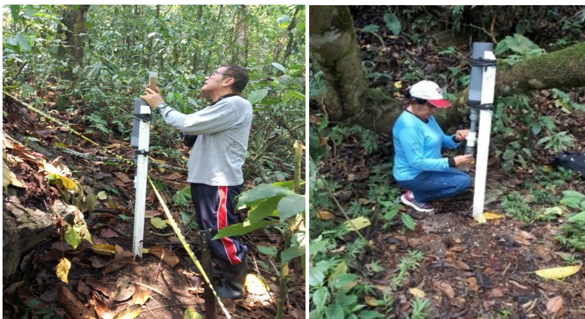
Figura 9 - Pluviômetros utilizados para medir a precipitação interna na mata ciliar do rio Huallaga - PNTM. 2023-2024.
