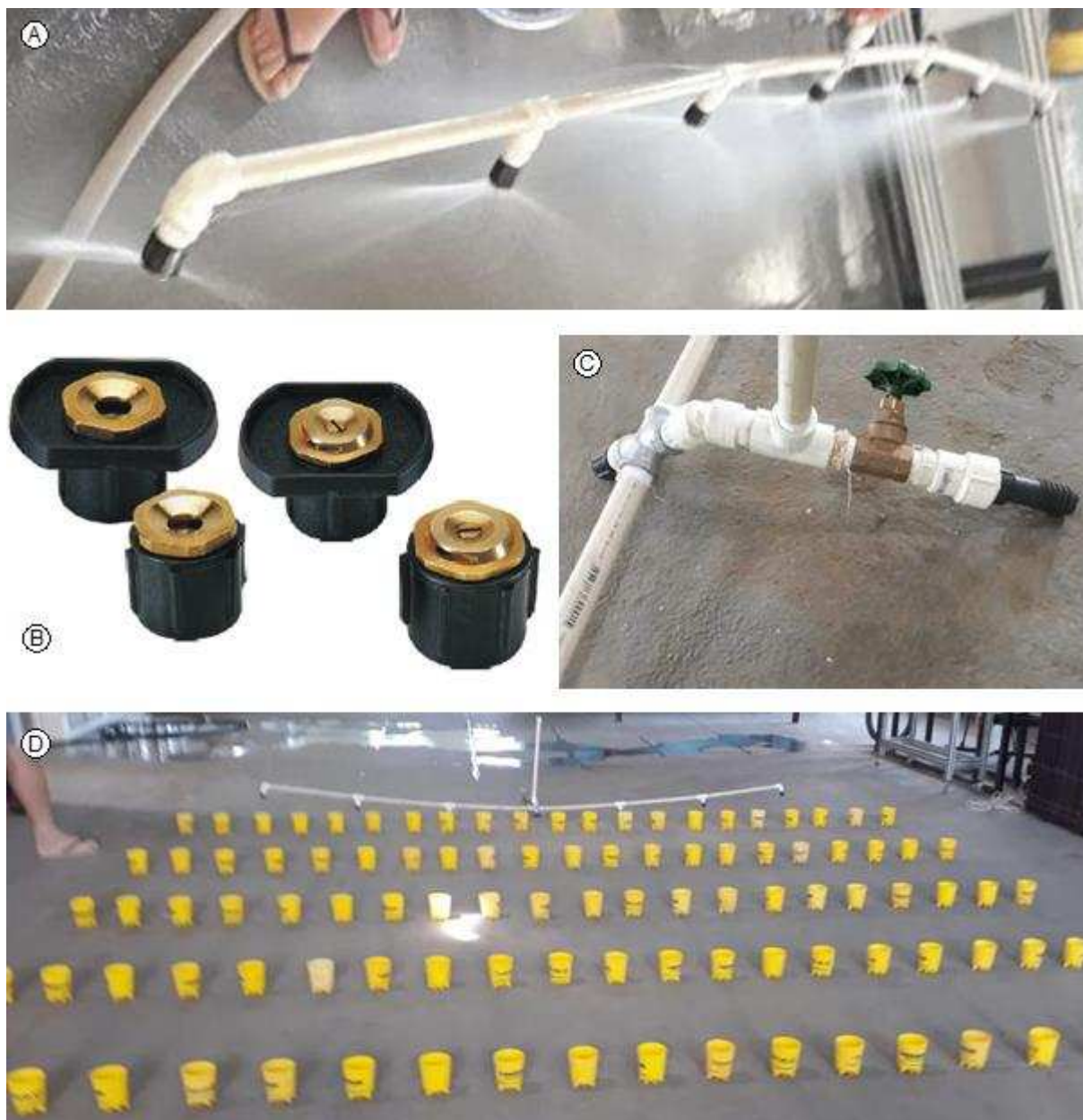
Figura 8 - Barra irrigadora (A), emissores SempreVerde da Fabrimar ® (B), base/suporte com as peças constituintes (C) e visão geral da distribuição dos pluviômetros para a avaliação do sistema (D).
