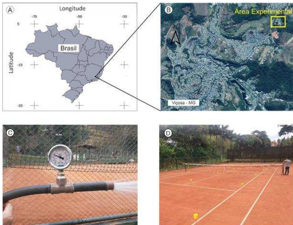
Figura 7 - Localizações da área experimental em relação ao Brasil (A), ao Município de Viçosa-MG (B), detalhe da mangueira com o emissor tipo chuveiro (C), e distribuição dos coletores na quadra de tênis (D).
