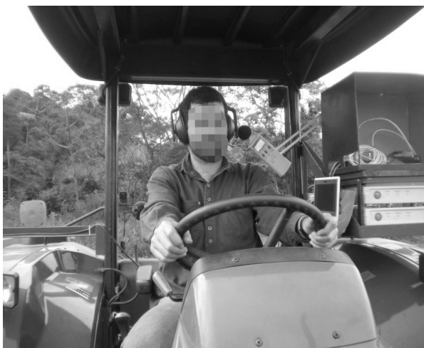
Figura 2. Decibelímetro instalado ao lado do ouvido esquerdo do operador do trator.
