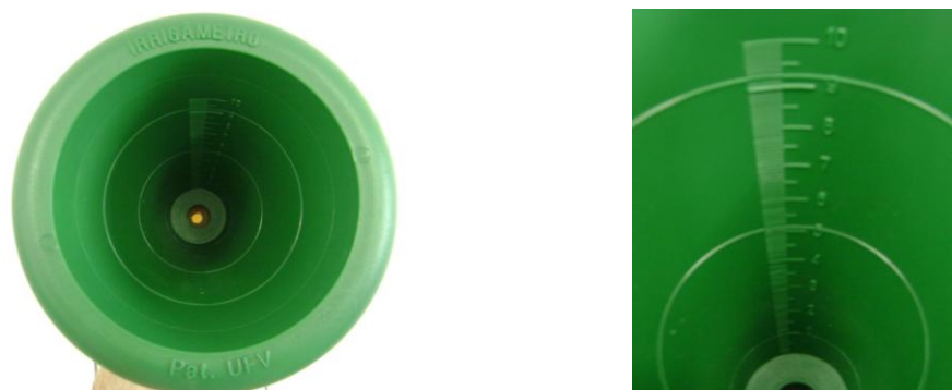
Figura 5 – Vista superior mostrando o formato cônico e detalhe da régua de nível na parede interna do evaporatório.
