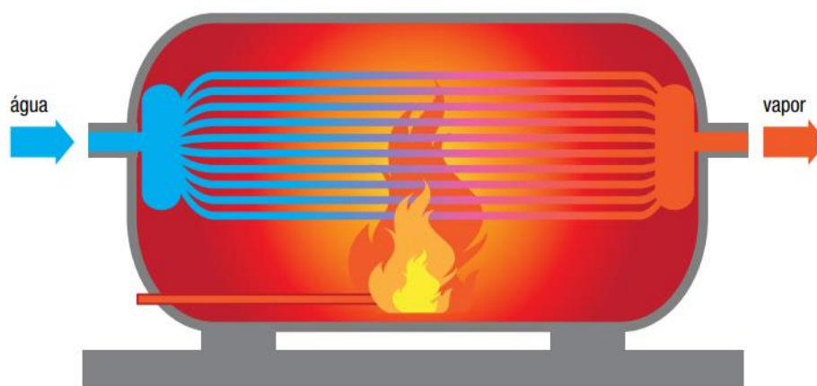
Figura 8: Representação esquemática de caldeira aquatubular.
