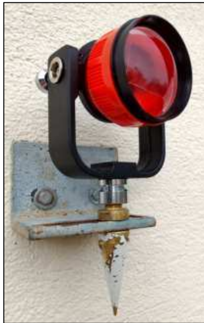
Figura 3 – Ilustração do prisma acoplado à placa com auxílio do parafuso.
