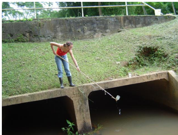
FIGURA 6: Coleta de água subsuperficial
