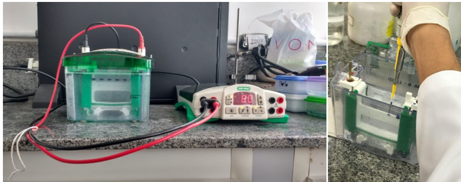
Figura 11 - SDS-PAGE realizado para separar as proteínas de acordo com o peso molecular.
