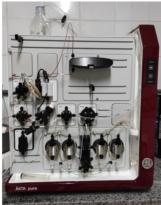
Figura 12 - Equipamento de cromatografia líquida (FPLC) utilizado para purificação da proteína no experimento
