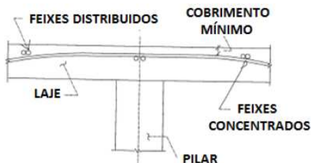
Figura 26 – Feixes de cordoalhas sobre o apoio.
