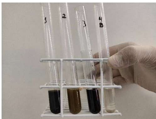
Figura 8) Fotografia do resultado da reação de proteínas com o acetato de chumbo, tubo 1 – concentrado de proteína, tubo 2 – leite em pó, tubo 3 – clara de ovo e tubo 4 – branco.
