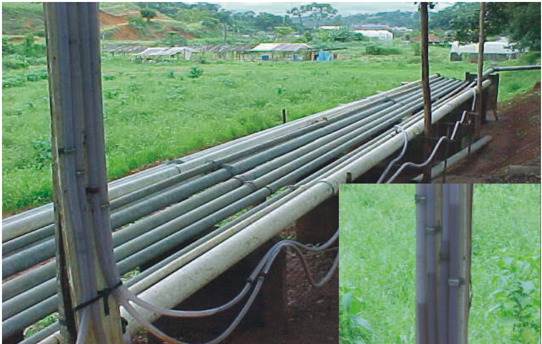
Figura 4 – Vista parcial da bancada de ensaios mostrando a tubulação em nível e a posição dos piezômetros, com detalhe da indicação da perda de carga nos piezômetros
