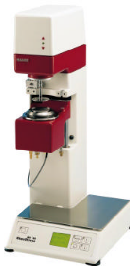
Figura 8 – Reômetro Rheostress RS 150 utilizado na caracterização reológica da ARA
