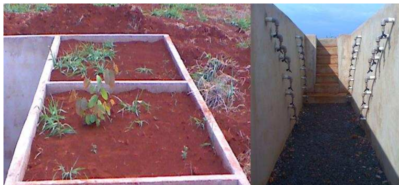
Figura 3 – Lisímetros após o levantamento das paredes, divisão dos blocos e instalação dos coletores de água.
