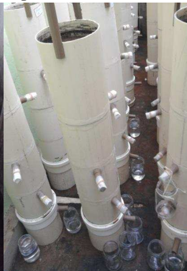
Figura 3 – Colunas de lixiviação: (A) após a aplicação dos herbicidas, (B) coleta das amostras de água.
