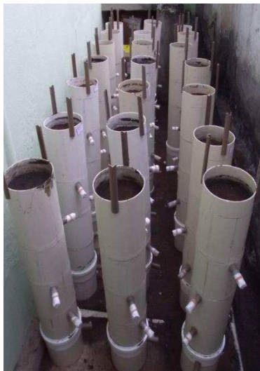
Figura 3 – Colunas de lixiviação: (A) após a aplicação dos herbicidas, (B) coleta das amostras de água.
