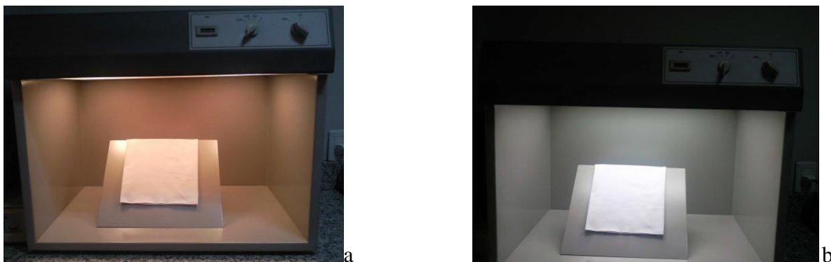
Figura 23 – Cabine de luz simulando iluminante A (a) e iluminante D65(b)
