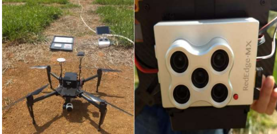
Figuras 3 e 4 - Drone Matrice 100 DJI e câmera multiespectral Micasense REDEEDGE. Fonte: LISBOA, 2020.
