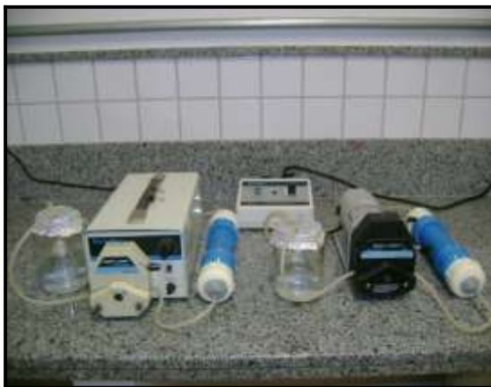
Figura 2 - Sistema experimental para formação do biofilme de P. fluorescens em meio mínimo de sais, por cinco dias consecutivos, a 25 °C.
