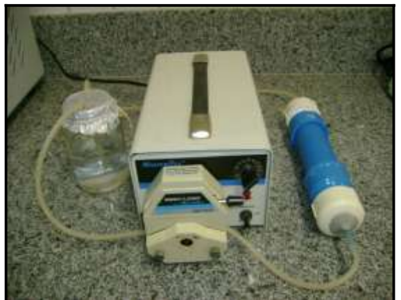
Figura 2 - Sistema experimental para formação do biofilme de P. fluorescens em meio mínimo de sais, por cinco dias consecutivos, a 25 °C.
