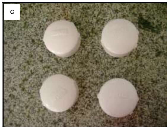
Figura 1 - Composição dos reatores utilizados no experimento: (a) tubulação de poli (cloreto de vinila); (b) tampas rosqueáveis furadas; (c) tampas rosqueáveis sem furo; (d) mangueiras de silicone.
