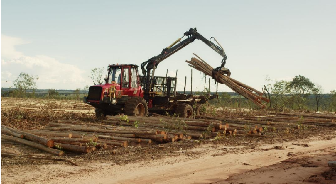
Figura 2: Forwarder Komatsu modelo 895 utilizado como fonte de dados para operação de baldeio utilizada nessa pesquisa. Fonte: Divulgação Komatsu.
