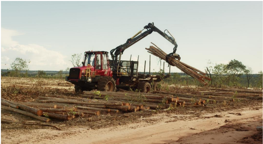
Figura 9: Forwarder Komatsu modelo 895 utilizado como fonte de dados para operação de baldeio utilizada nessa pesquisa. Fonte: Divulgação Komatsu.
