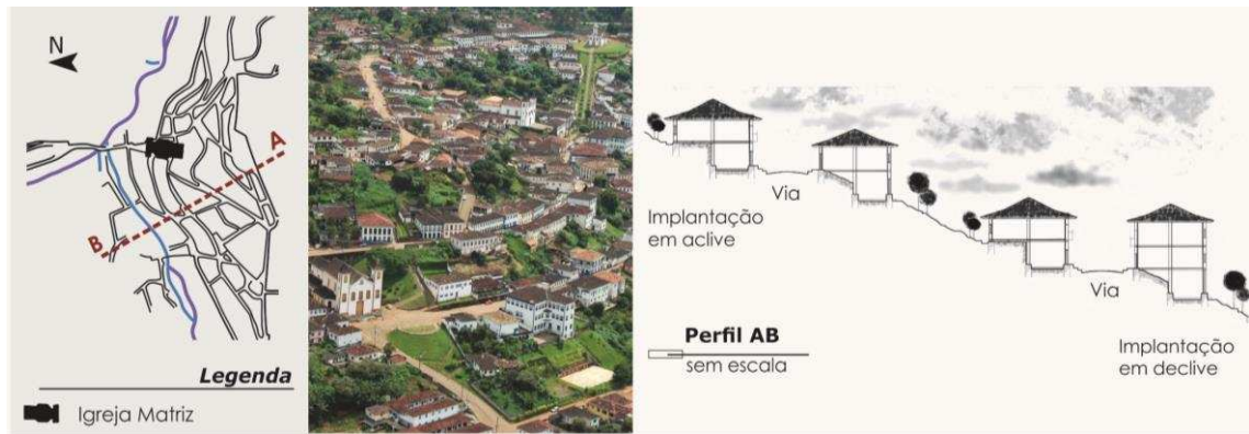
Figura 26 – Perfil de implantação das edificações no núcleo antigo.
