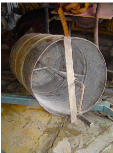
Figura 3.5 – Tambor de 200 litros com haste hélice
