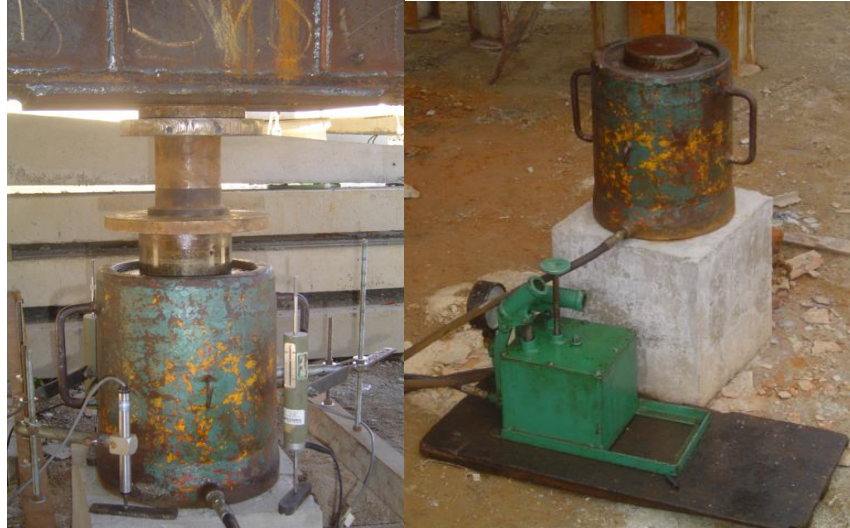
Figura 3.27 – Extensômetros elétricos (LVDT), bomba e macaco hidráulico 02
