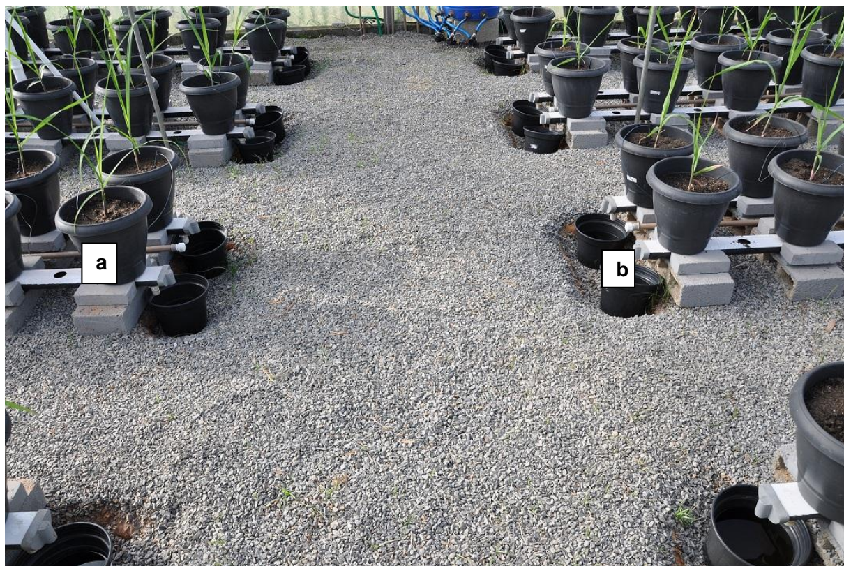
Figura 5 - Vista geral do sistema de drenagem. Perfil hidropônico (a) e vasos para armazenamento do excedente da fertirrigação (b).
