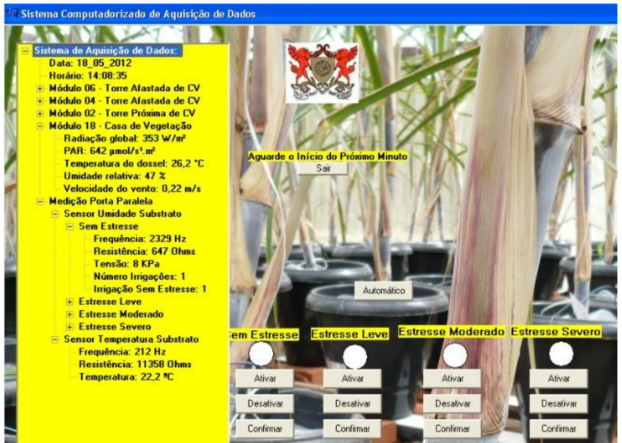
Figura 8 – Interface do programa de aquisição de dados e controle das motobombas de fertirrigação.
