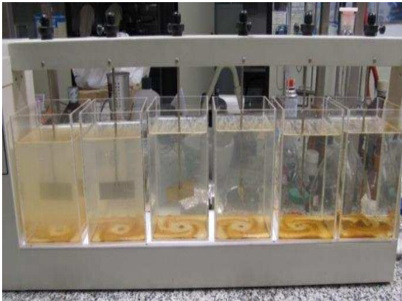
Figura 1. Montagem experimental do reator de coagulação convencional (a) e de eletrocoagulação (b).
