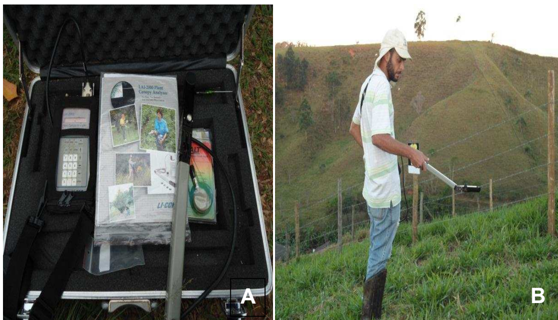
Figura 9 - Aparelho analisador de dossel da marca licor (A) utilizado para o monitoramento da interceptação luminosa pelo dossel forrageiro (B).
