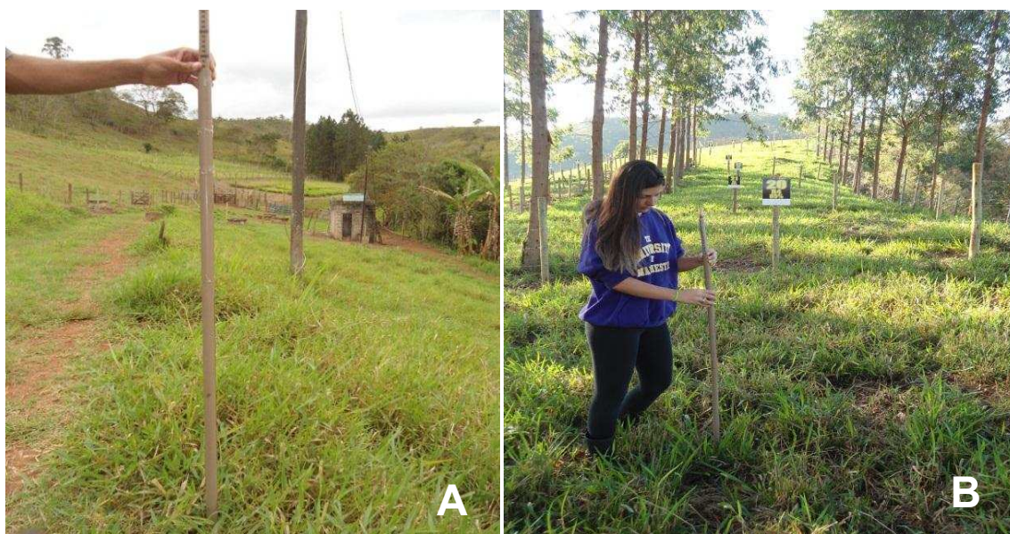
Figura 8 – Tubo de PVC graduado em cm (A), utilizado para monitorar a altura do pasto (B).
