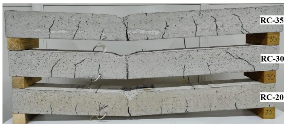
Figura 7 – Mecanismo de falha das vigas
