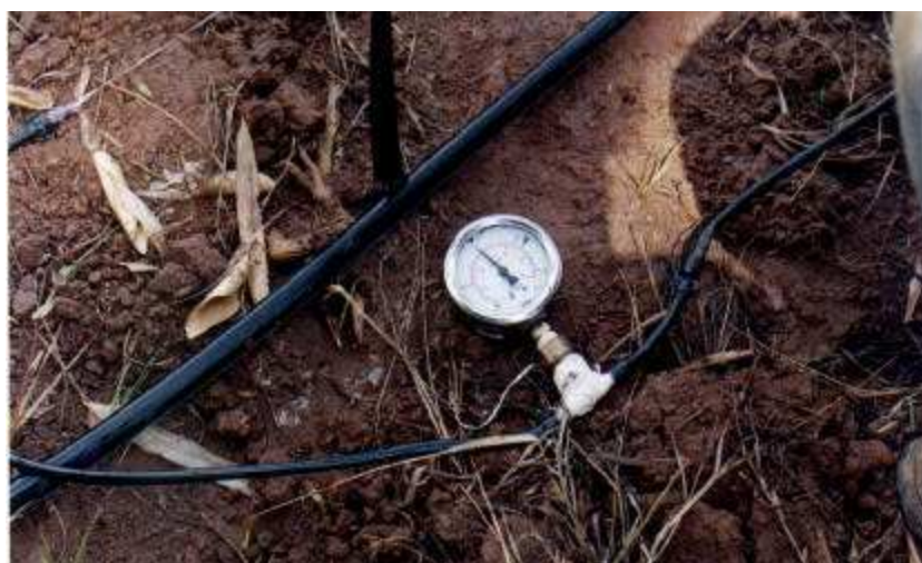
Figura 4 - Manômetro utilizado na regulagem da pressão do microaspersor.
