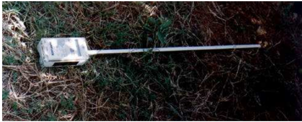
Figura 5 - Ceptômetro utilizado para medição da radiação interceptada pelas árvores.
