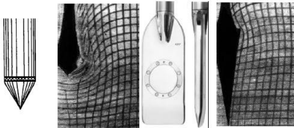
Figura 2.6 Comparação da camada deformada pela sonda do ensaio de cone e a lâmina dilatométrica (Baligh e Sott, 1975).
