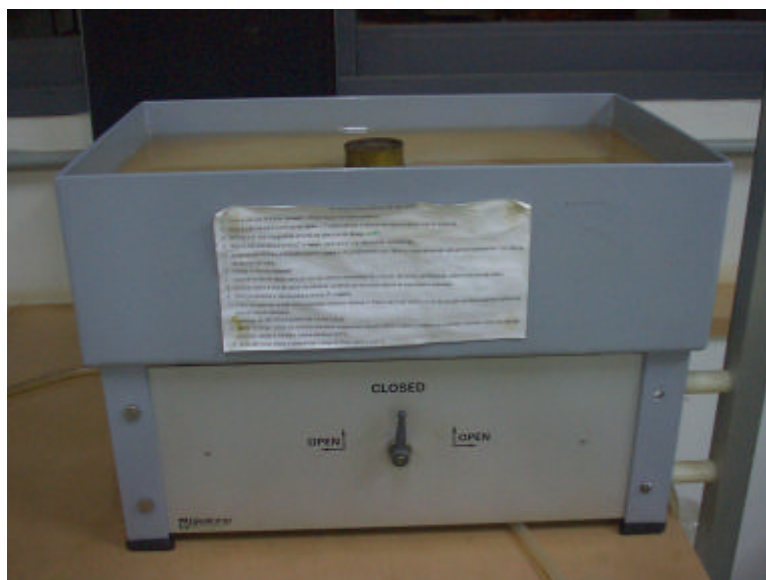
Figura 3.4 Foto parcial da mesa extratora do Departamento da Física dos Solos - caixa contendo silte e areias especiais.
