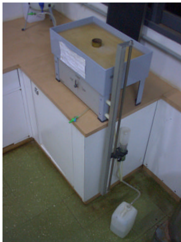
Figura 3.3 Foto da mesa extratora do Departamento da Física dos Solos.
