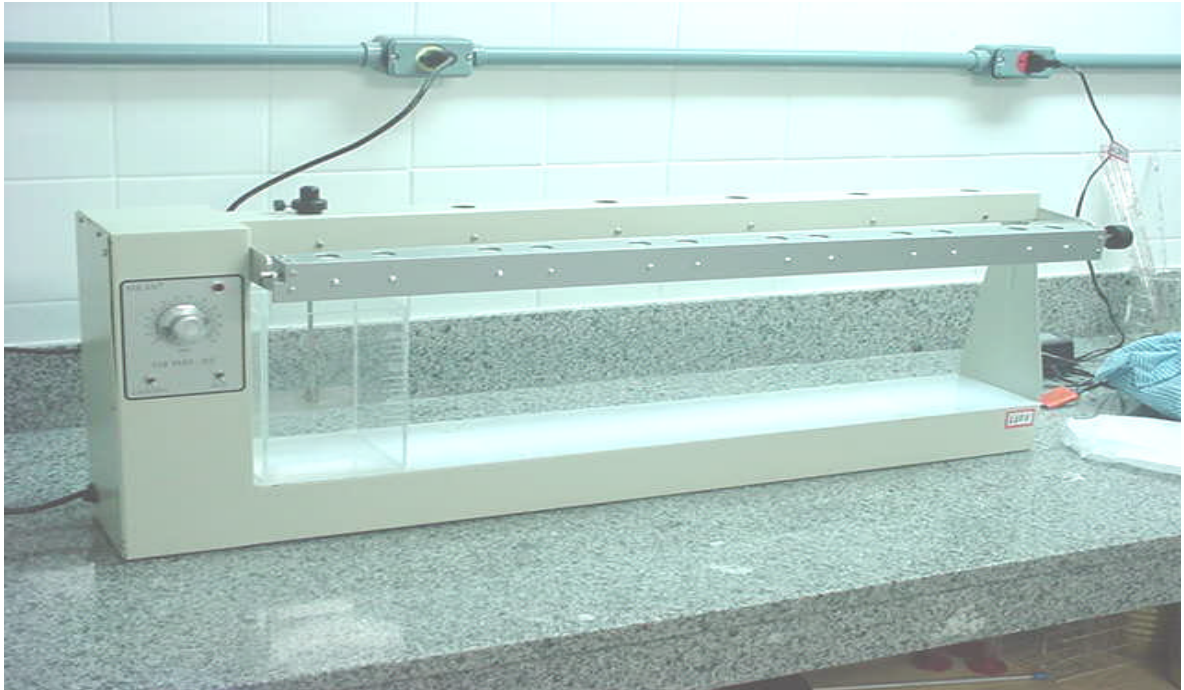
Figura 8 - Representação do equipamento usado para ensaio de coagulação, floculação e sedimentação (Jar-Test).
