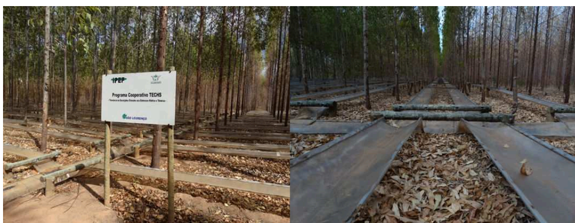
Figura 3. Estrutura de lonas plásticas no estilo calhas, montado para retirada parcial da água das chuvas, em Coração de Jesus - MG. Foto: Josimar Rodrigues Oliveira, 2015.
