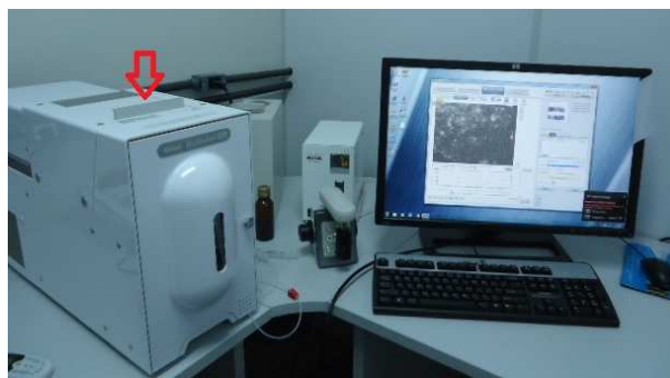
Figura 3.1: Equipamento Bio Station IMQ . A seta em vermelho indica a localização do porta amostra.
