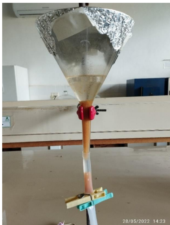
Figura 15 – Aparato de separação de MPs e sedimentos por densidade
