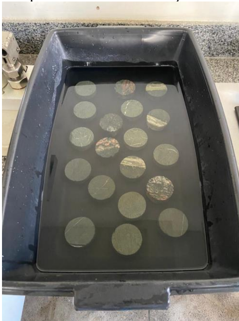
Figura 3.4 - Corpos de prova imersos em solução de sulfato de sódio.
