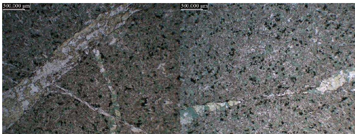
Figura 7: Aspecto das venulações da terceira família. Na imagem é possível observar esta venulação cortando as venulações da primeira e segunda família. Imagem em luz transmitida plano polarizada com a objetiva de 2,5x. Figura 8: Aspecto das venulações da quarta família. Imagem em luz transmitida plano polarizada com a objetiva de 2,5x.
