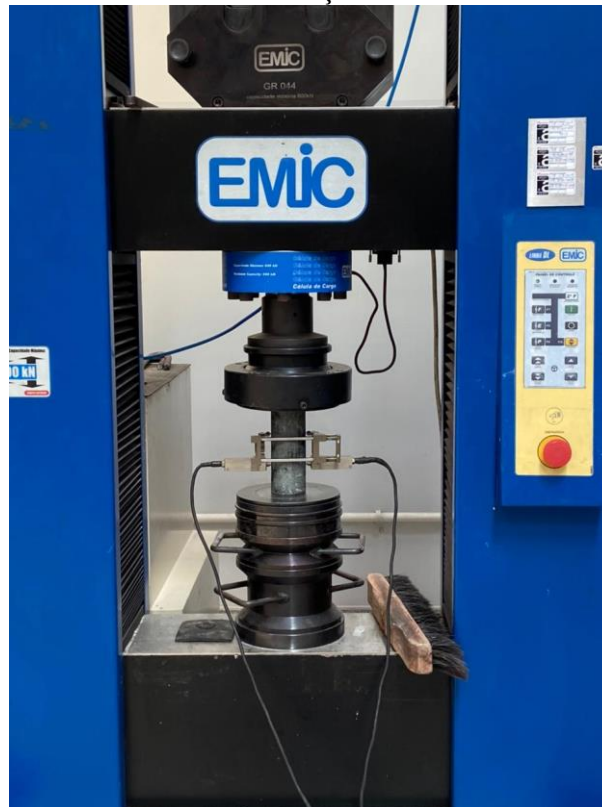
Figura 3.9 - Montagem ensaio de resistência a compressão com instrumentação para medida de deformação
