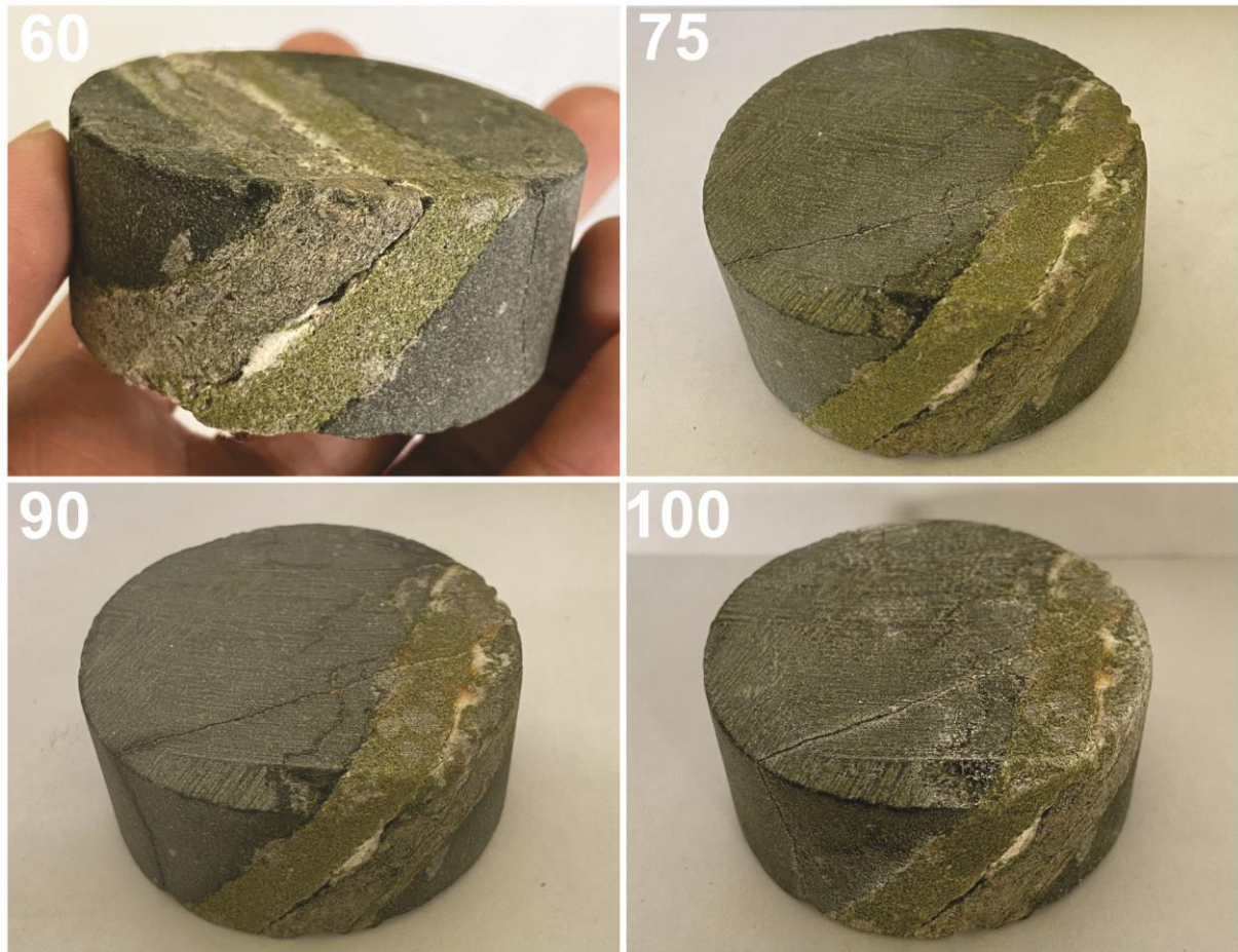
Figura 4.14 – Evolução visual do corpo de prova n° 44, nos ciclos 60, 75, 90 e 100.
