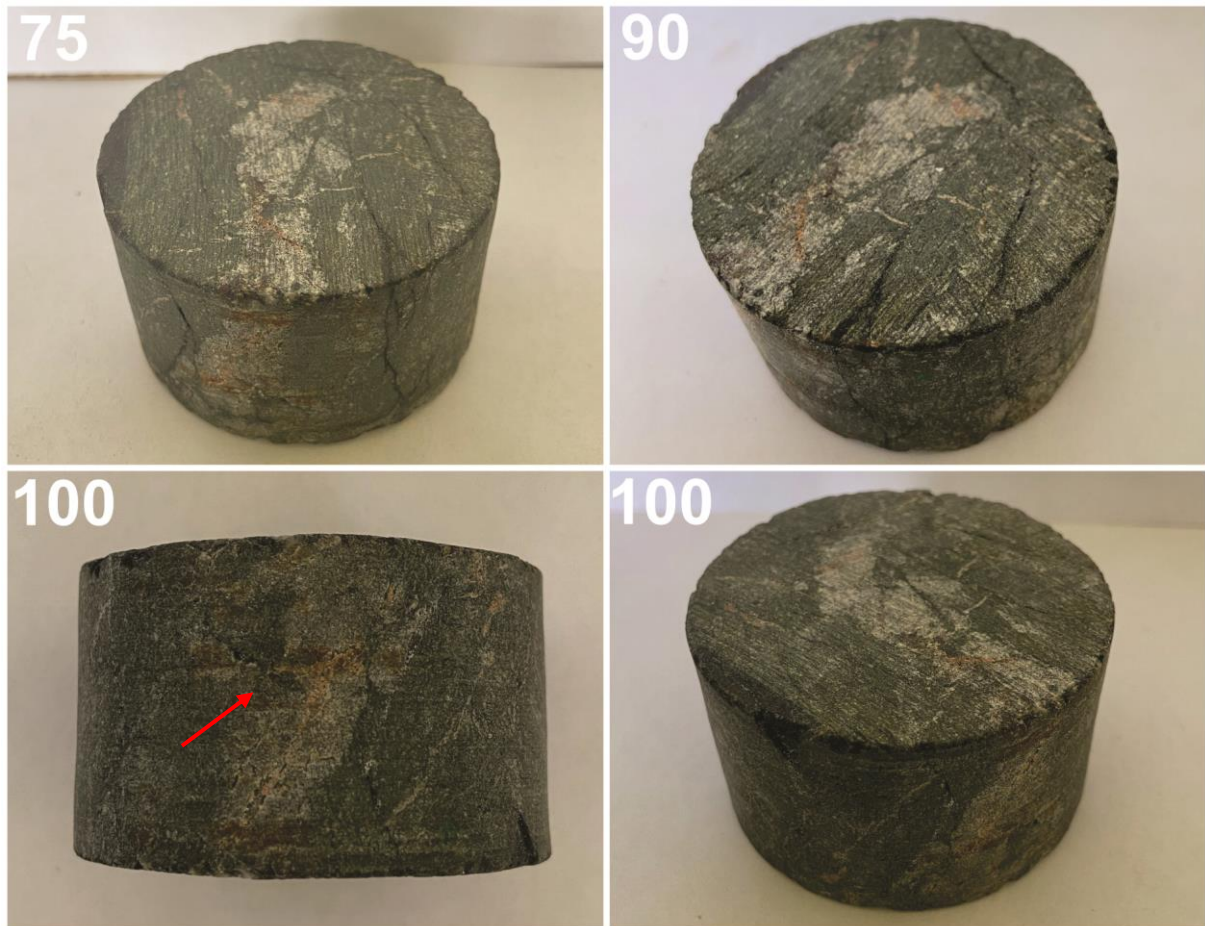
Figura 4.12 – Evolução do estado visual do corpo de prova n° 19, nos ciclos 75, 90 e 100.
