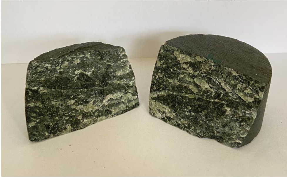
Figura 4.18 – Paredes interiores da rachadura do corpo de prova n° 17.
