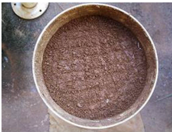
Figura 2 – Detalhe do preenchimento da coluna de solo, com a primeira camada de areia e brita (a); e detalhe da escarificação após o adensamento de uma camada na coluna de solo (b).
