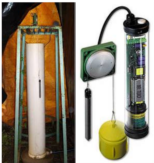
Figura 4 – Medidor de nível da água proveniente do escoamento superficial das colunas de solo, utilizado no experimento.
