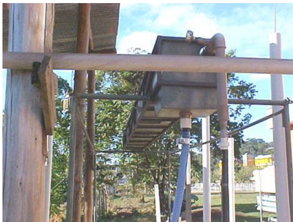
Figura 5 - Simulador de chuvas utilizado no experimento.
