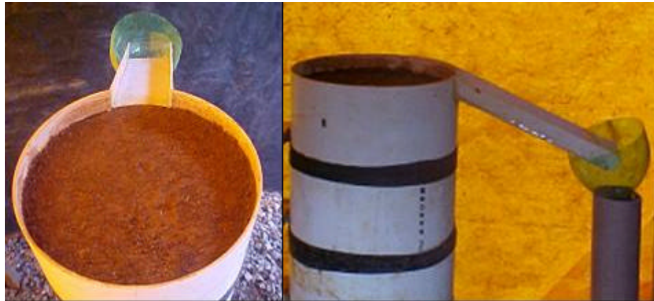
Figura 3 – Detalhe da calha fixada na parte superior da coluna de solo utilizada para coletar o escoamento superficial.
