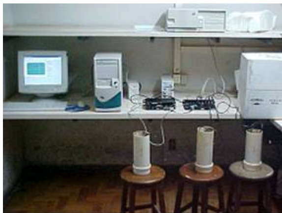
Figura 1 – Sonda de TDR utilizada no experimento (a); recipientes utilizados na calibração das sondas de TDR (b); e leituras da constante dielétrica utilizando o equipamento TDR100 (c).
