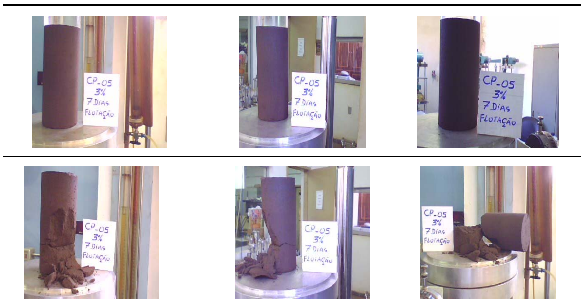
Figura 4.9: Ensaio de resistência à compressão simples do rejeito da flotação melhorado com 3 % de cimento aos 7 dias de cura
