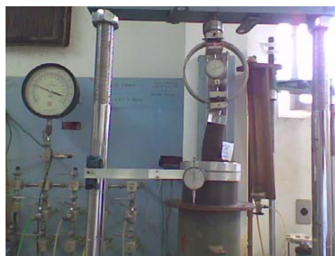
Figura 3.15: Detalhe da prensa triaxial
