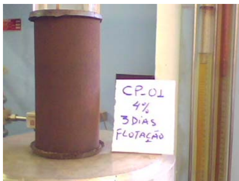
Figura 3.14: Registros dos ensaios de resistência à compressão simples
