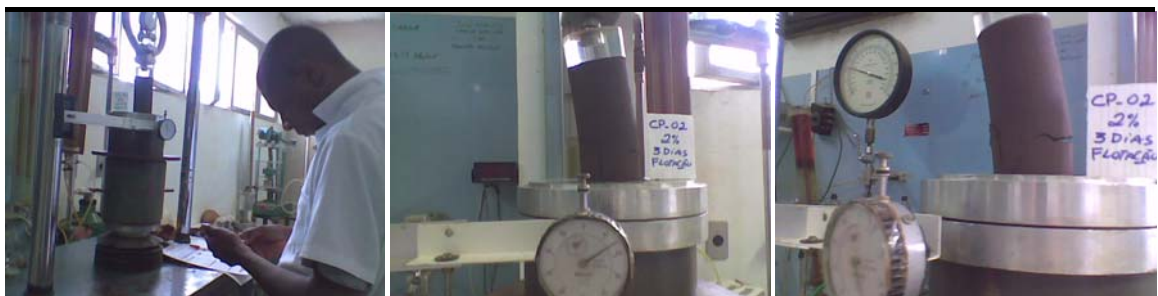
Figura 4.8: Ensaio de resistência à compressão simples do rejeito da flotação melhorado com 2 % de cimento aos 3 dias de cura
