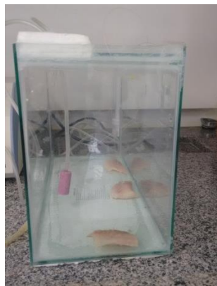
Figura 2.2. Câmara de fumigação (ozônio gasoso).
