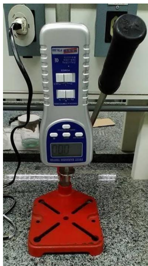
Figura 2.6. Penetrômetro usado para análises de firmeza.
