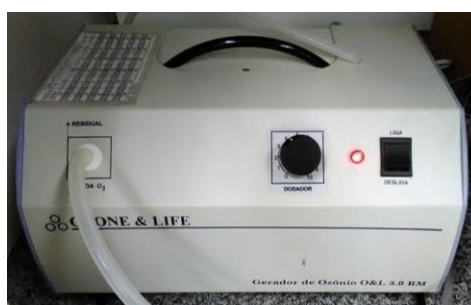
Figura 2.1. Gerador de ozônio da marca Ozone & Life utilizado no processo de ozonização.
