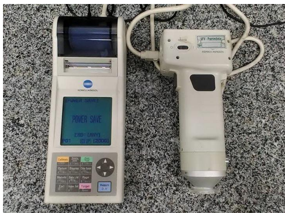
Figura 2.4. Colorímetro da Minolta (modelo CR-400), usado para análise de cor.
