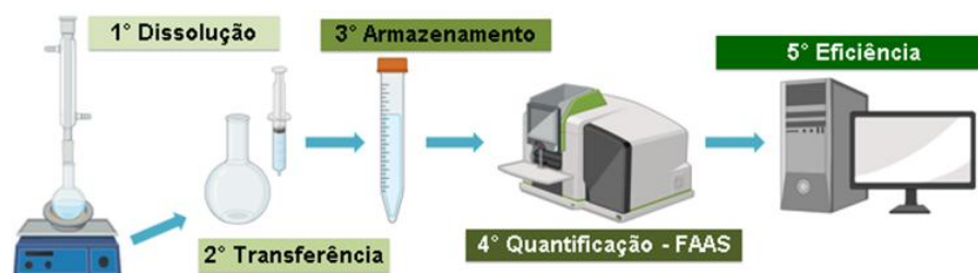
Figura 5. Processo hidrometalúrgico para caracterização química da amostra em \text{HNO}_3 7,00 mol \text{L}^{-1} ; 70 °C; 1h; 1:25.
