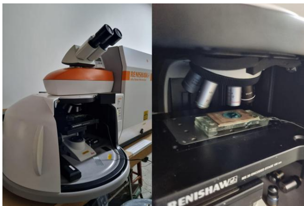
Figura 3. Espectrofotômetro Raman e a célula eletroquímica contendo a solução de sulfato de cobre produzido através de resíduos eletrônicos como eletrólito para formação dos microdepósitos de cobre.
