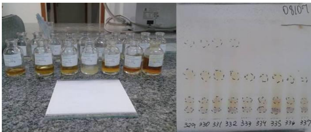
Figura 10: Perfil obtido por CCD e frações de EAE eluídas da coluna de sílica, após.
