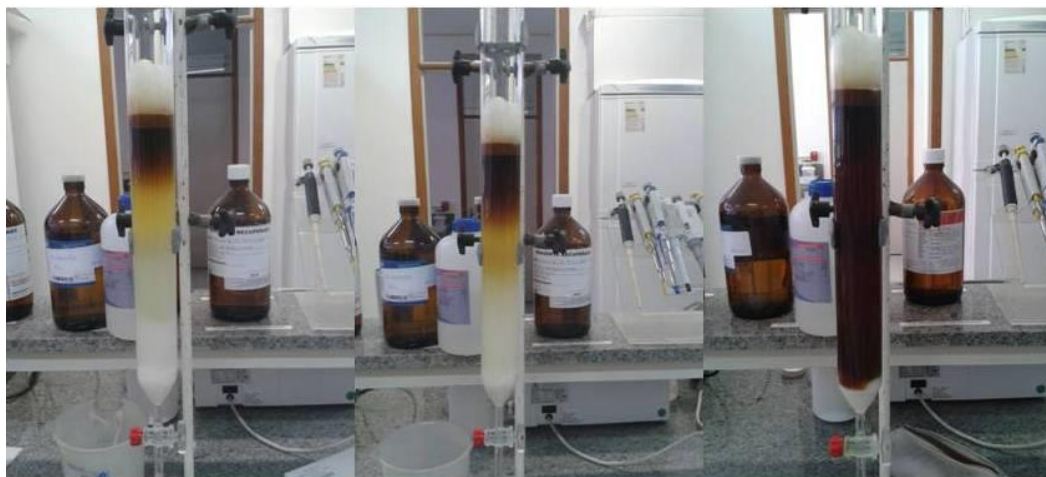
Figura 9: Fracionamento cromatográfico do EAE em coluna de sílica gel em três diferentes fases da eluição.
