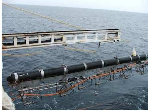
Figura 3.20: Esta fotografia mostra a operação de colocação ( deployment ) de um subarranjo na água [47].
