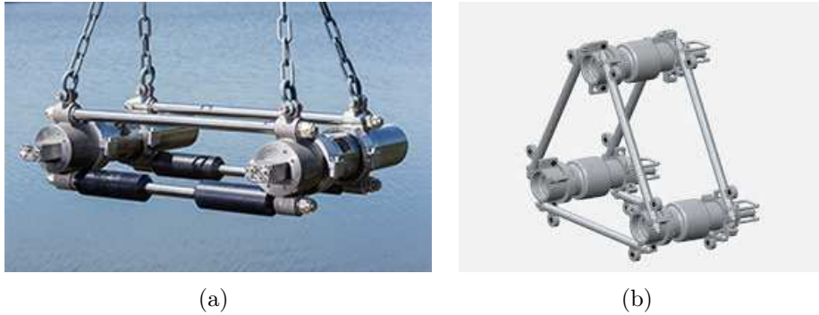
Figura 3.27: (a) Cluster composto por 2 air guns (2-gun cluster) [48]. (b) Cluster composto por 3 air guns (3-gun cluster) [49].
