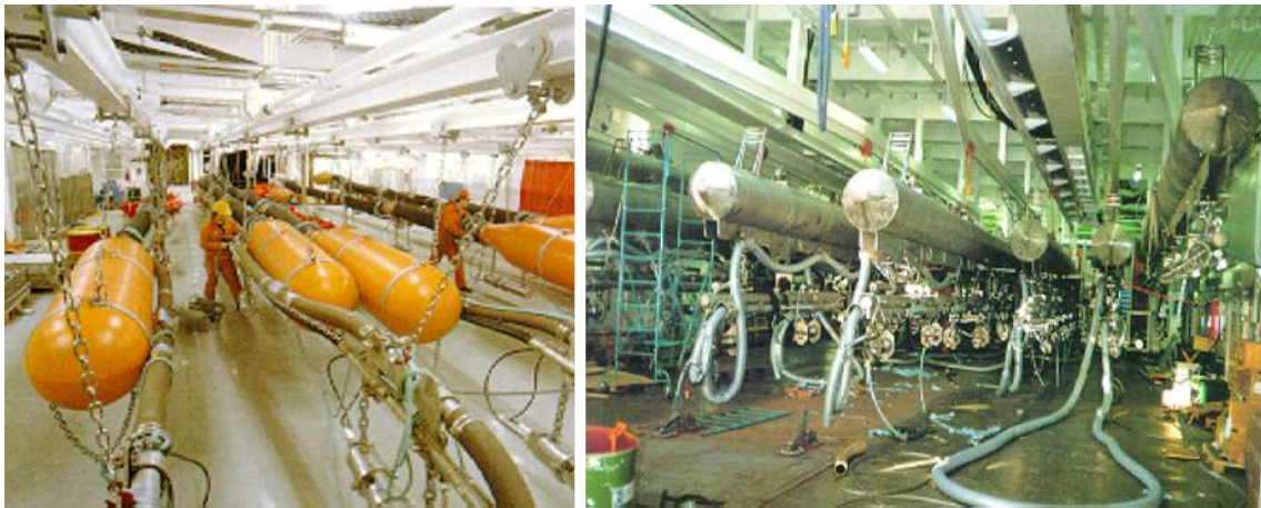
Figura 3.19: Esta fotografia mostra o gundeck de dois navios. Esta é a parte do navio onde os subarranjos ficam localizados quando não estão em operação ou quando estão em manutenção [46].
