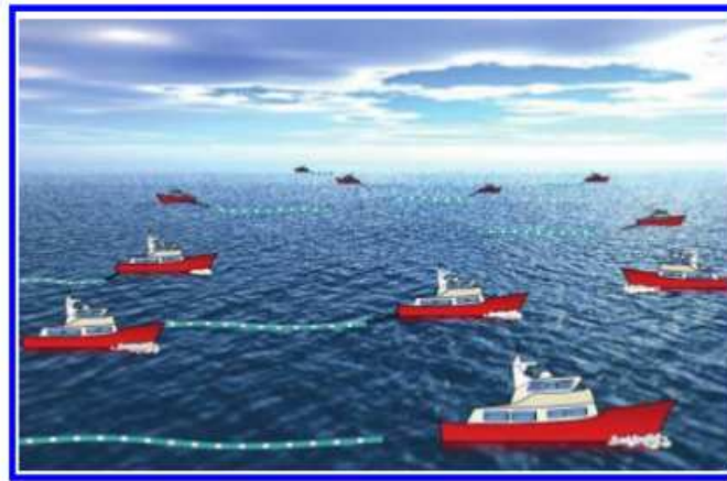
Figura 4.3: Alguns navios fonte não tripulados rebocando cada um uma fonte narrowband e um cabo, no conceito de fontes dispersas - DSA, cumprindo espaço e temporalmente os requisitos necessários para corretamente iluminar a subsuperfície. A amostragem espacial das fontes e as profundidades destas dependem da característica de frequência que se deseja com cada fonte [55].
