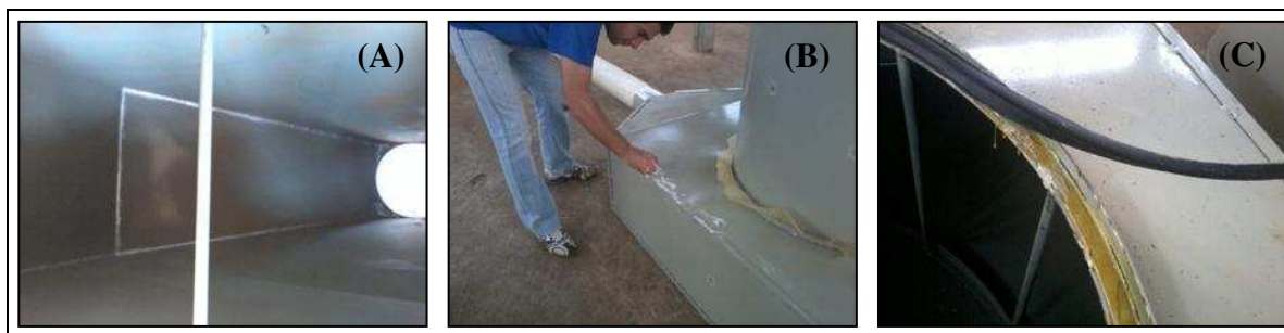
FIGURA 6. Acabamento do Protótipo para Medição da Queda de Pressão Estática do Ar: (A) – calafetagem das uniões; (B) – verificação de vazamentos; (C) – colagem da borracha no encaixe.
