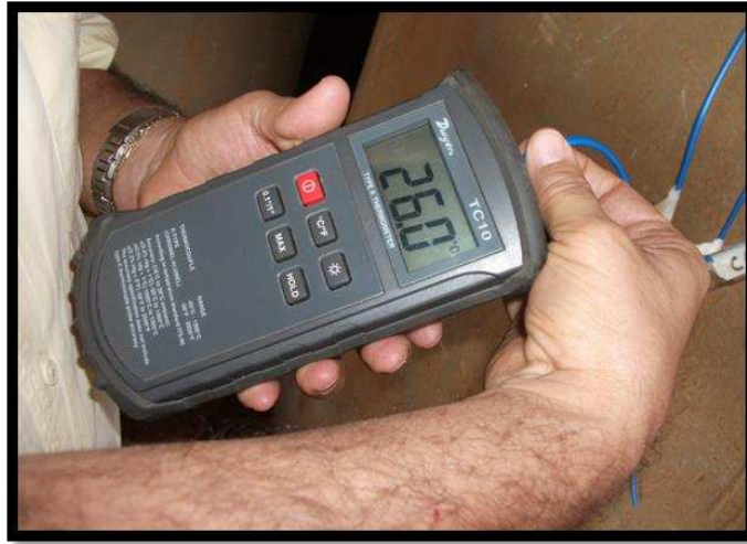
Figura 3 - Termômetro digital com um termopar acoplado, indicando a temperatura no interior do silo.
