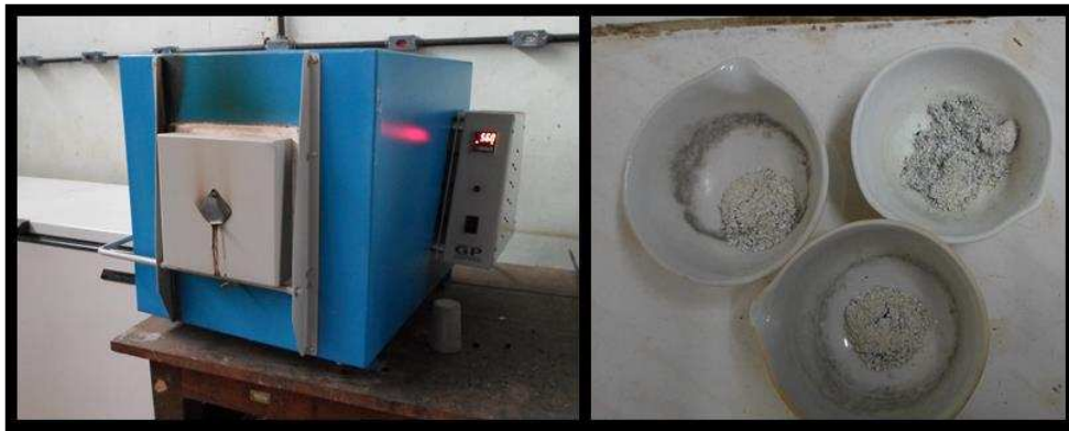
Figura 12 - Mufla e cadinhos de porcelana com as cinzas, após a execução do teste de teor de cinzas para o feijão.
