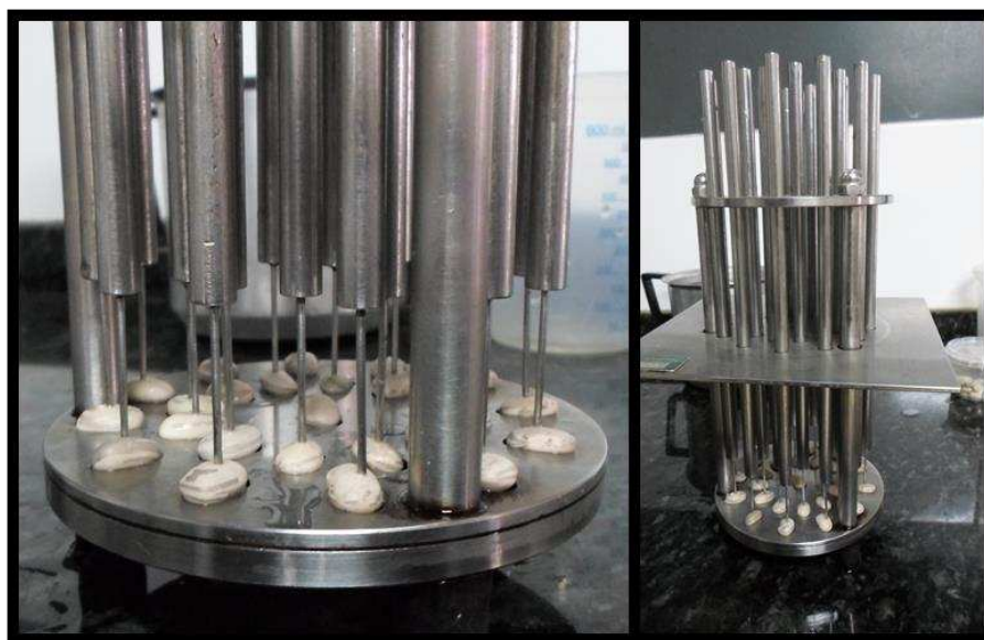
Figura 13 - Cozedor Mattson com os grãos de feijão posicionados sob as hastes, durante a execução do teste de tempo de cocção.
