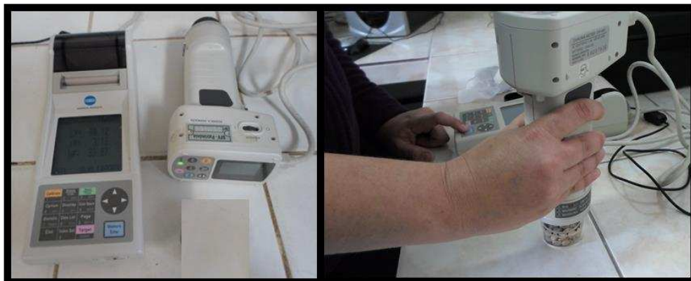
Figura 15 - Espectrofotômetro de bancada durante a realização da determinação da cor para o feijão.
