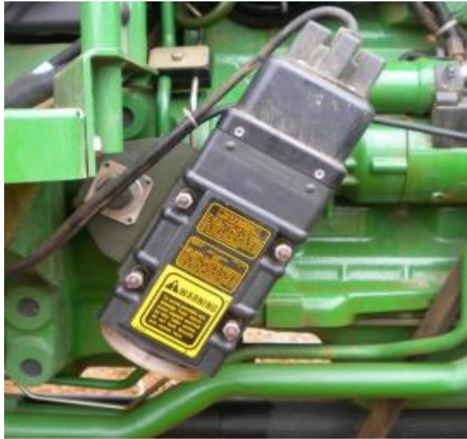
Figura 18 - Radar para monitoramento de velocidade durante o experimento
