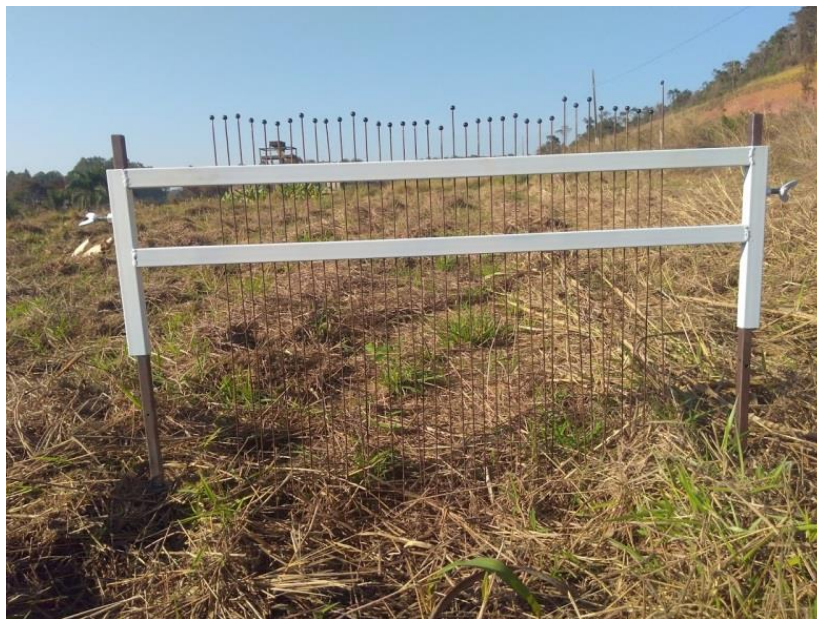
Figura 15 - Perfilômetro utilizado para a caracterização do perfil de rugosidade do solo
