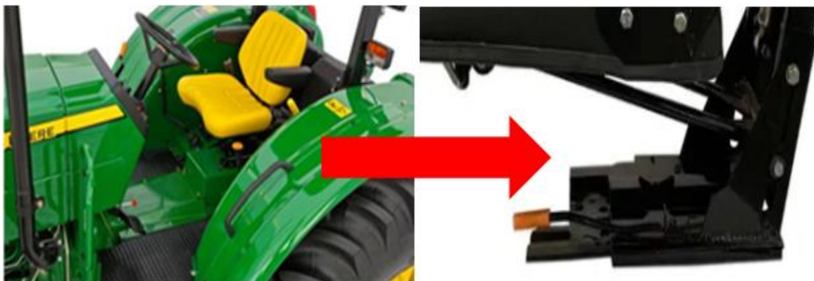
Figura 25 - Assento do trator John Deere modelo 5705 4x2 TDA e detalhamento do sistema de amortecimento do assento
