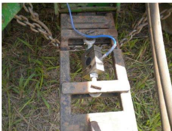
Figura 20 - Célula de carga e suporte para instalação no trator
