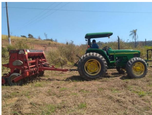
Figura 17 - Conjunto trator semeadora-adubadora para plantio direto marca SEMEATO®, modelo SHM 11/13
