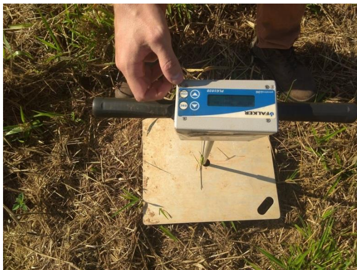
Figura 12 - Penetrômetro digital utilizado para a caracterização da área experimental
