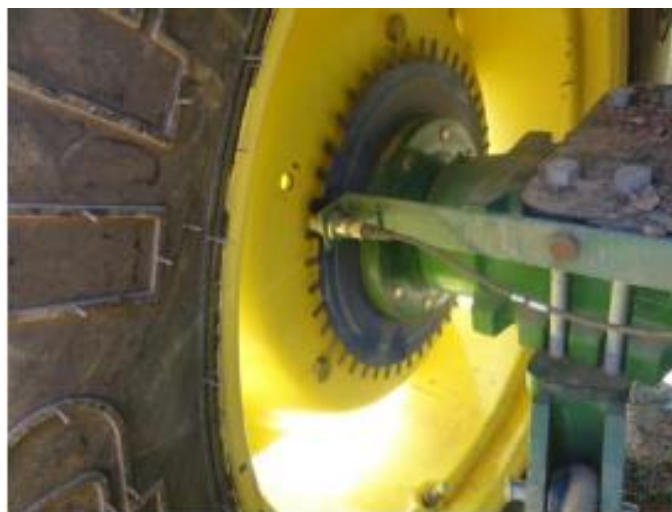
Figura 19 - Sensor indutivo para a determinação da velocidade rotacional dos rodados
