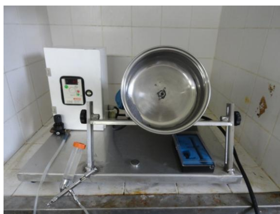
Figura S1.2.1. Sistema de granulação rotativa utilizado na granulação dos fertilizantes, com rotação e inclinação ajustáveis e injeção de aglutinante via pistola pneumática.
