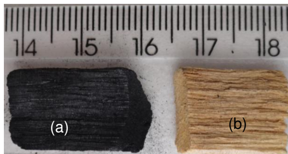
Figura S1.1.2. Madeira de eucalipto pirolisada a 350° por 1 h (a), e madeira de eucalipto antes da pirólise (referência métrica em cm).
