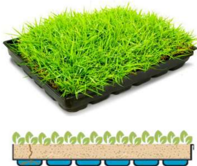
Figura 21 - Sistemas modulares de telhados verdes e corte representativo
