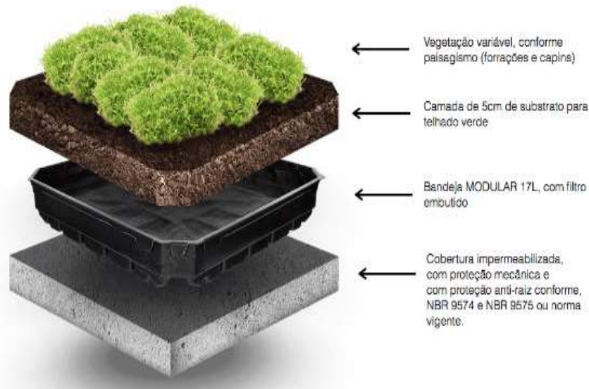
Figura 25 - Sistema modular para telhado verde
