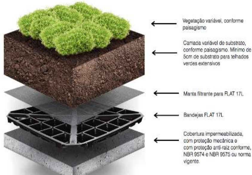
Figura 38 - Sistema flat de telhado verde
